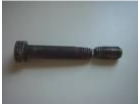
Gambar baut tertarik dan patah
