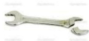
Gambar Kunci Pas patah
