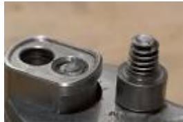
Gambar Kepala baut patah
