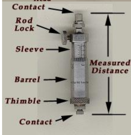
Gambar Mikrometer Dalam untuk pengukuran 5 – 30 mm
